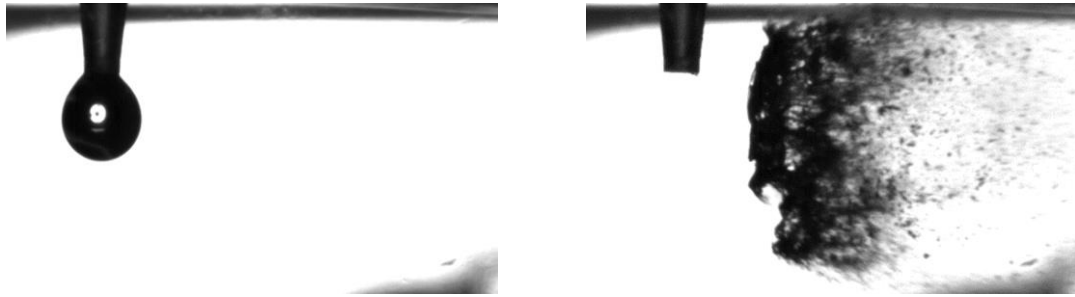
図1 衝撃波による液滴の変形・微粒化.
